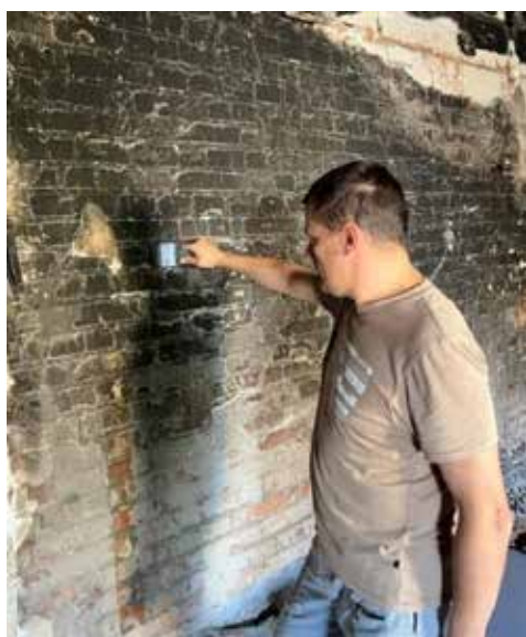
Рис. 6. Пошук арматури за допомогою приладу «ПОИСК-М»
