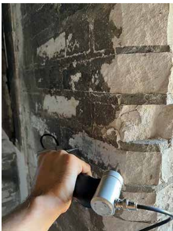
Рис. 7. Визначення глибини тріщин
